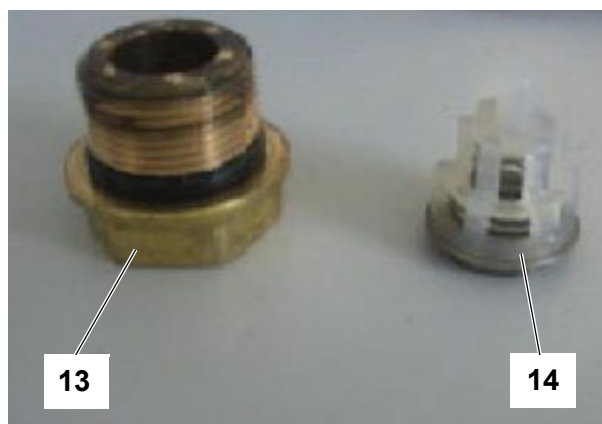
Ventilhalter und Ventil (ausgebaut und getrennt)
