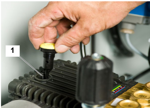
Öleinfüllöffnung mit Peilstab
